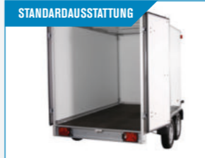
STANDARDAUSSTATTUNG Lichtdurchlässiges Dach. Mit Doppelstegplatten, welche nicht kondensieren.
