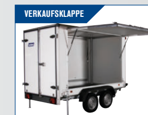
VERKAUFSKLAPPE Große Öffnung in der Seite mit sturmsicheren Stoßdämpfern.
