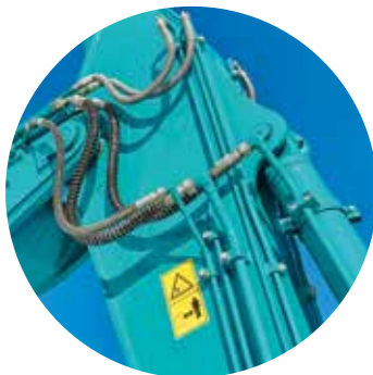
➤ Zusätzlicher Schutz für Schlauchleitungen
