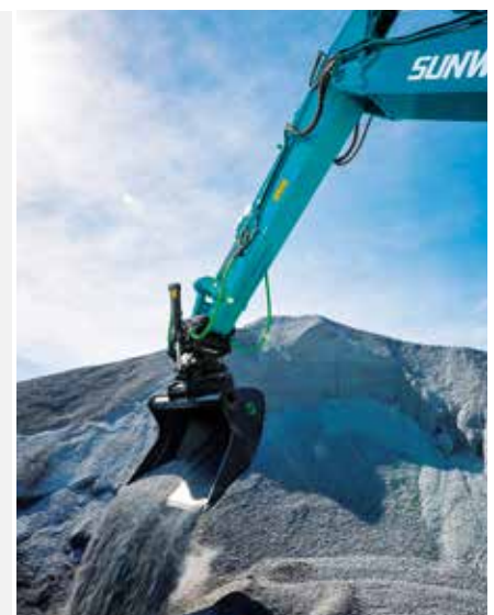
3 Zusatzleitungen als Serienausrüstung sorgen für einfaches Arbeiten mit Tilt-Rotatoren
