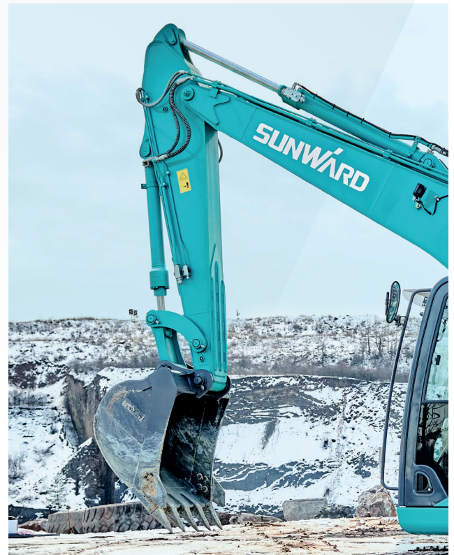
Le balancier et l'articulation de godet ont été conçues pour une longévité standard de 20 000 heures.
