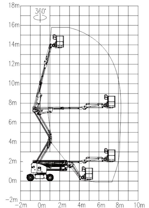
Die Arbeitshöhe entspricht der Plattformhöhe plus 2 m.
